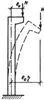
а) на колонну действует продольная сила  $N$ , приложенная с эксцентриситетом  $e_0$
